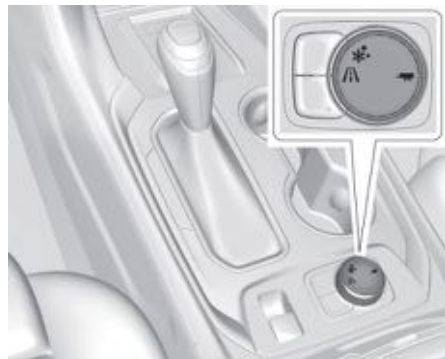
Рукоятка переключателя режимов движения (переднеприводный автомобиль)
