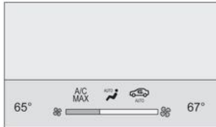
Экран состояния системы климат-контроля
