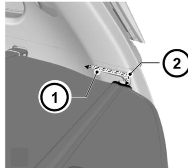
Извлеките язычки шторки для багажа из направляющих с обеих сторон багажного отделения, и шторка автоматически втянется (1). Чтобы развернуть шторку для багажа, вытяните ее из механизма втягивания и вставьте два язычка в направляющие с обеих сторон багажного отделения (2).
