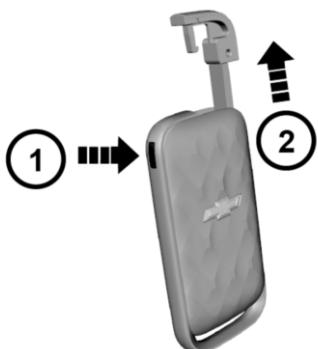
Поверните фиксатор (1) на ключе и вытяните механический ключ (2). После использования вставьте механический ключ обратно.
