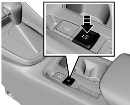
Когда двигатель работает, ремень безопасности водителя пристегнут, и боковая дверь водителя закрыта, необходимо нажать на выключатель AVH, при этом загорается лампа подсветки выключателя и активируется функция AVH. После этого при соблюдении следующих условий загорается индикатор работы AVH на комбинации приборов. Стояночный тормоз функционирует, и тормозная система прикладывает соответствующее тормозное усилие для удержания автомобиля в состоянии парковки.
