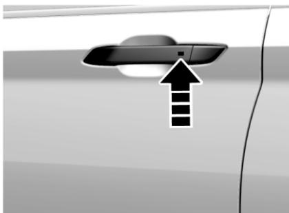
Если двери заперты и ключ зажигания находится в положении LOCK, приблизьте ключ на расстояние ближе 1,2 м от ручки передней двери. Нажмите кнопку на ручке, и система проверит действительность ключа. После подтверждения действительности ключа система отпирает все двери. Фонари аварийной световой сигнализации мигнут один раз.
