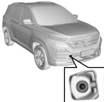
С правой стороны переднего бампера автомобиля имеется закрытое крышкой отверстие. Под крышкой находится отверстие для установки буксирного крюка.
