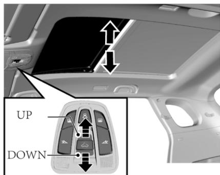
Переднюю часть панорамной крыши можно наклонять.
