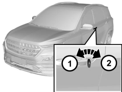
Чтобы запереть дверь снаружи ключом, вставьте ключ и поверните его по часовой стрелке (2). Чтобы отпереть дверь, поверните ключ против часовой стрелки (1).
