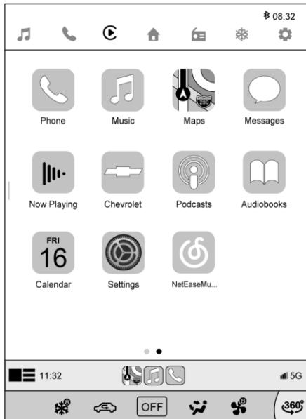
Чтобы проецировать содержимое экрана телефона на автомобильный дисплей, подключите телефон к информационно-развлекательной системе с помощью кабеля USB. После этого вы сможете управлять некоторыми приложениями через информационно-развлекательную систему. Приложения CarPlay и Android Auto обеспечивают навигацию, воспроизведение музыки, телефонную связь, голосовое управление и другие функции вождения.
