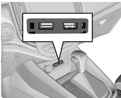
Разъем питания внешних устройств находится под панелью управления кондиционера.
