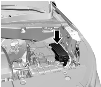
Блок предохранителей в моторном отсеке находится рядом с аккумуляторной батареей.
