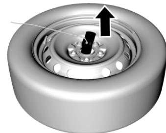
3. Наклоните крепежную пластину на конце троса и вытяните ее из центрального отверстия колеса.
