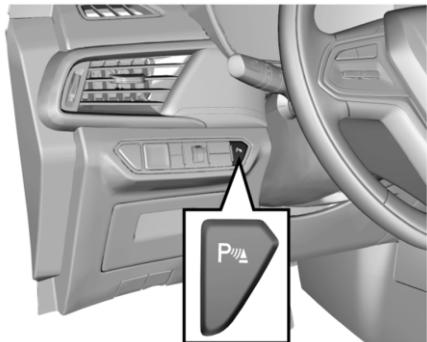
Если автомобиль оборудован выключателем системы облегчения парковки, то после включения выключателя зажигания и нажатия выключателя системы облегчения парковки загорается индикатор выключателя. Если в этот момент отпустить стояночный тормоз, начинает работать система облегчения парковки.
