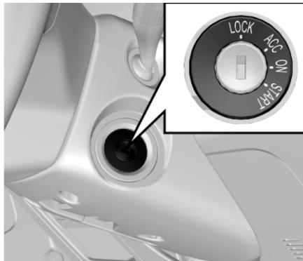
На выключателе зажигания с правой стороны рулевой колонки предусмотрены следующие рабочие положения:
