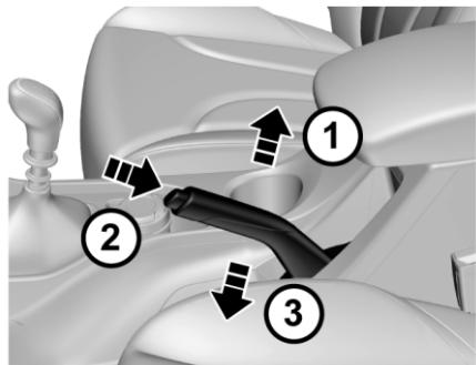
Стояночный тормоз действует на задние колеса.
