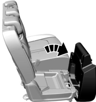
После разблокировки вытяните подушку вперед, поднимите ее заднюю часть и переверните подушку. Можно перевернуть обе подушки.
