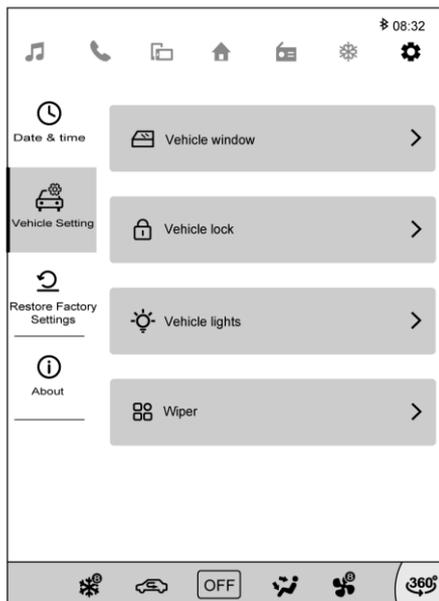
Нажмите значок Vehicle Setting (Настройки автомобиля), чтобы открыть экран настроек автомобиля. Здесь можно настроить параметры окон, освещения, стеклоочистителей и запираания дверей.
