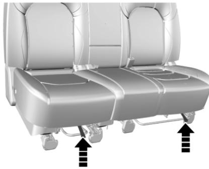
В передней нижней части подушек сидений находятся два шнура разблокировки подушки. Подушку сиденья можно разблокировать, потянув соответствующий шнур.
