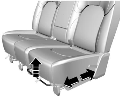
Чтобы отрегулировать положение сиденья вперед или назад, потяните вверх рычаг регулировки, установленный на передней нижней части сиденья. После установки
