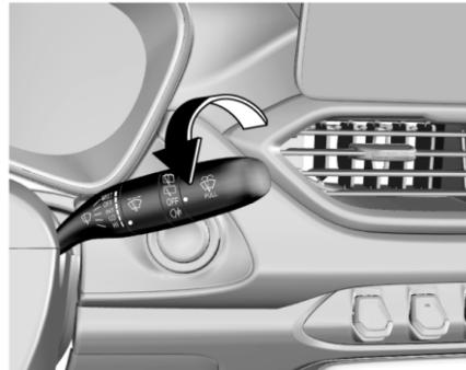
Чтобы включить задние противотуманные фары, когда передние фары находятся в режиме ближнего света или включены передние противотуманные фары, поверните ручку управления задним стеклоочистителем в положение и затем отпустите. Чтобы выключить задние противотуманные фары, поверните ручку еще раз.
