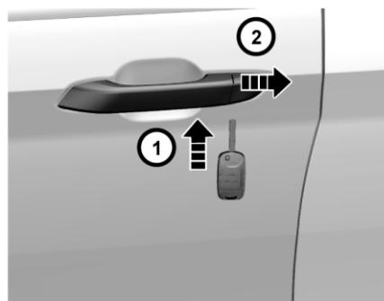
Замочная скважина на наружной ручке левой передней двери скрыта под декоративной накладкой. Чтобы открыть дверь ключом, нужно снять декоративную накладку. Такой способ открывания двери используется, если радиобрелок RKE
