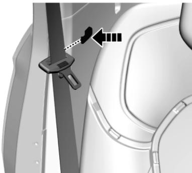
На панели отделки рядом со спинкой сидений второго ряда имеется держатель. Вешайте ремень безопасности на держатель для хранения каждый раз после использования.
