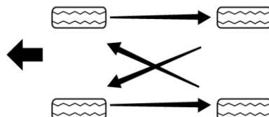
Передние и задние шины выполняют разные функции и потому по-разному изнашиваются. Шины на передних колесах изнашиваются быстрее, чем на задних.
