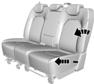
Угол наклона спинки сиденья регулируется. Прежде всего, удерживайте спинку сиденья, так как после вытягивания ремня отпускания спинка быстро складывается и может ударить или травмировать. Затем тяните шнур отпускания спинки, находящийся сбоку сиденья, назад, пока не будет достигнут требуемый угол наклона спинки.
