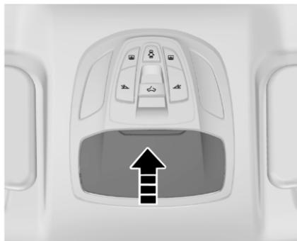
Если предусмотрено комплектацией, в потолочной консоли имеется отсек с крышкой для солнечных очков. Нажмите на наружную крышку, и консоль откроется автоматически. После использования закройте.
