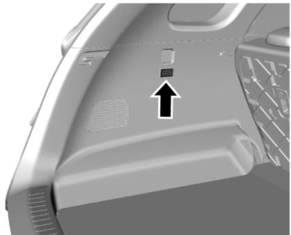
Подсветка багажного отделения загорается при открывании двери багажного отделения. После закрывания двери багажного отделения она гаснет.
