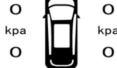
Система контроля давления в шинах (TPMS) показывает текущее давление и температуру во всех четырех шинах.
