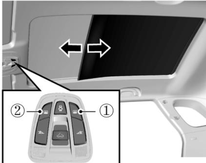
Нажмите на переключатель открывания или закрывания солнцезащитной шторки, сдвиньте его в направлении открывания или закрывания и отпустите, когда шторка окажется в нужном положении. При коротком однократном нажатии на переключатель солнцезащитная шторка автоматически открывается и закрывается.
