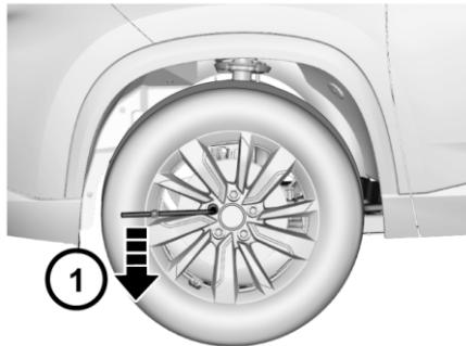
1. Выньте инструменты, домкрат и запасное колесо. Проследите, чтобы расположенное по диагонали колесо было зафиксировано клиньями, колодками или камнями.
