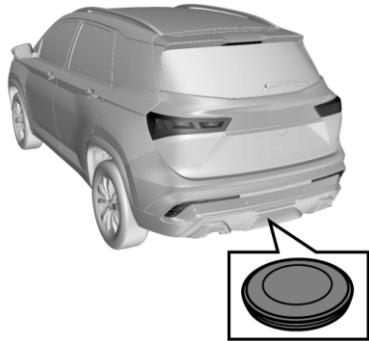
Запасное колесо 7-местной модели находится под полом в задней части автомобиля.
