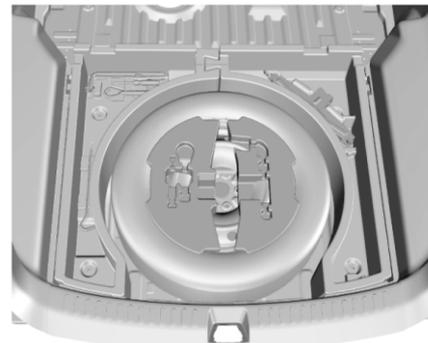
Запасное колесо, домкрат и инструменты находятся под полом багажного отделения; чтобы до них добраться, необходимо поднять пол багажного отделения.
