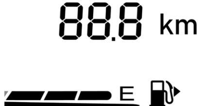
Счетчик текущего пробега показывает расстояние, пройденное в текущей поездке с момента предыдущего обнуления счетчика. Чтобы сбросить счетчик текущего пробега, нажмите на рулевом колесе кнопку «вниз» и удерживайте ее 2 секунды.
