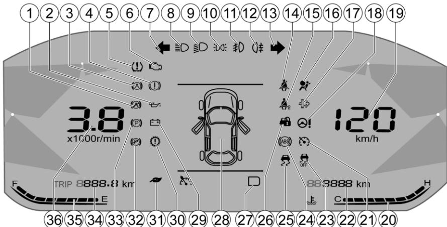
1. Сигнализатор неисправности системы автоматического удержания автомобиля (AVH) (если предусмотрена)
