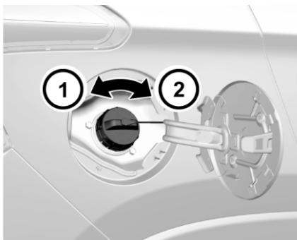
3. Плавно поверните крышку заливной горловины против часовой стрелки (1). Если услышите шипящий звук, подождите, пока звук не прекратится, а затем открутите крышку.
