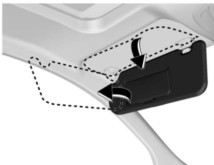
Ваш автомобиль оборудован солнцезащитным козырьком, который позволяет уменьшить ослепление водителя и пассажира переднего сиденья. Козырек можно перемещать вверх, вниз и в стороны. В зависимости от конфигурации в козырьке может быть предусмотрен карман для хранения или зеркало.
