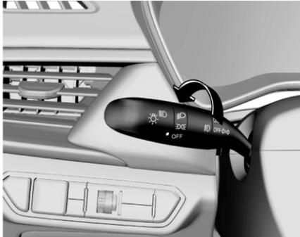
Чтобы включить передние противотуманные фары, когда ключ зажигания находится в положении ON и передние блок-фары работают в режиме габаритных фонарей или ближнего света, поверните кольцо в середине комбинированного переключателя в положение ON (ВКЛ).
