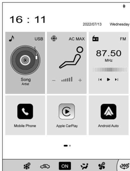
1. На главной странице отображаются значки для доступа к функциям музыкальной системы, кондиционера и радиоприемника.
