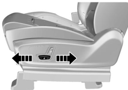
Выключатель электропривода регулировки находится с наружной стороны сиденья. Сдвиньте выключатель вперед или назад, и сиденье будет перемещаться соответственно вперед или назад. Отпустите выключатель, когда сиденье установится в требуемое положение.
