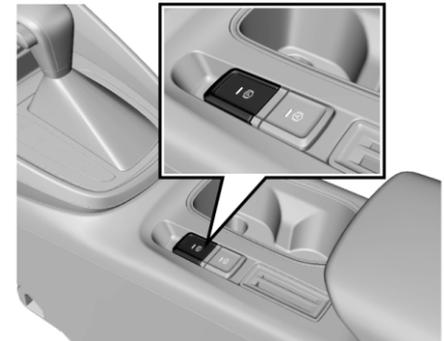
Стояночный тормоз действует на задние колеса. Выключатель стояночного тормоза с электронным управлением (EPB) находится между двумя сиденьями переднего ряда.
