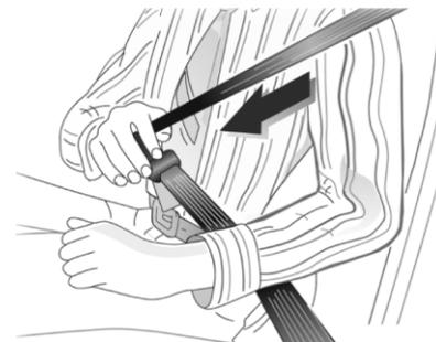
1. Вытяните ремень безопасности из смазывающего механизма и закрепите его на теле, не перекручивая.
