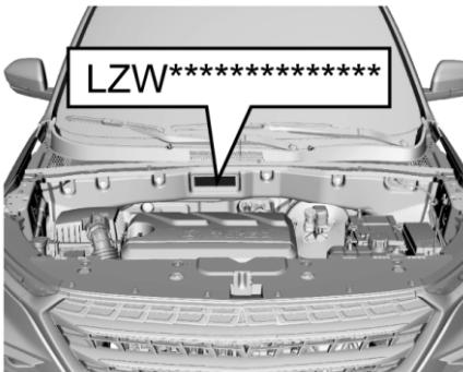
Расположен под капотом двигателя ниже стеклоочистителя.
