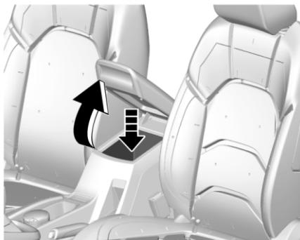
Отсек для хранения в подлокотнике находится между передними сиденьями. Чтобы открыть его, потяните крышку вверх. После использования отсека закройте крышку.
