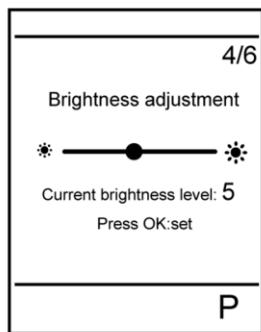
В меню регулировки яркости подсветки можно регулировать подсветку комбинированного указателя кнопками вверх/вниз на рулевом колесе. После завершения регулировки нажмите ОК, чтобы сохранить изменения и выйти из меню.
