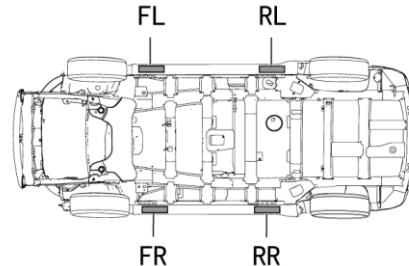
Точки поддомкрачивания находятся по бокам на юбке кузова и отмечены треугольными метками на соответствующих деталях.
