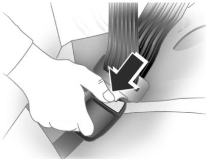
2. Вставьте язычок защелки в замок, чтобы закрепить ремень. Потяните плечевой ремень, чтобы отрегулировать натяжение поясного ремня.
