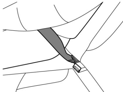
2. Вставьте язычок защелки на конце ремня безопасности в небольшой замок на левой стороне сиденья.
