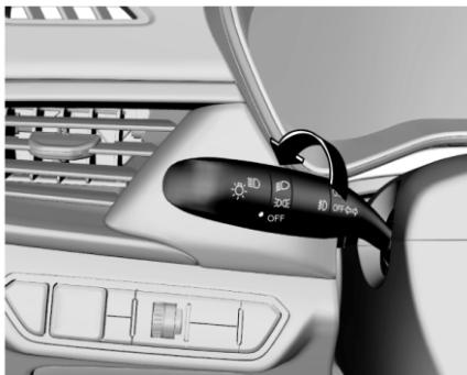
Чтобы включить передние противотуманные фары, когда ключ зажигания находится в положении ON и передние блок-фары работают в режиме габаритных фонарей или ближнего света, поверните кольцо в середине комбинированного переключателя в положение ON (ВКЛ). Поверните кольцо переключателя в положение OFF (ВЫКЛ), чтобы выключить передние противотуманные фары.
