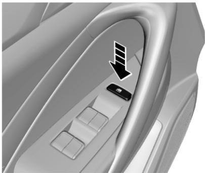
Кнопка блокировки электрических стеклоподъемников позволяет блокировать переключатели стеклоподъемников окна переднего пассажира и задних окон. Нажмите на кнопку, и все остальные переключатели электрических стеклоподъемников будут заблокированы. В этом режиме окнами можно управлять только с помощью кнопок панели управления на стороне водителя. Чтобы снять блокировку, нажмите кнопку еще раз.
