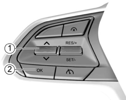
1. Кнопка селектора вверх/вниз Сдвиньте кнопку вверх или вниз, чтобы выбрать вариант или выполнить регулировку.
