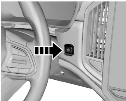
В соответствующей комплектации выключатель СТОП-СТАРТ ДВИГАТЕЛЯ находится внизу на правой стороне панели приборов.
