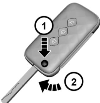
Нажмите на кнопку освобождения фиксации (1), механический ключ (2) раскроется автоматически.
