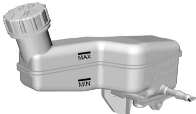
Прежде чем открывать заливную крышку бачка жидкости тормозной системы/сцепления, очистите область вокруг крышки.
