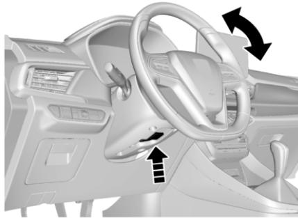
Регулируйте рулевое колесо только после полной остановки автомобиля. Рулевое колесо можно наклонять вверх/вниз.
