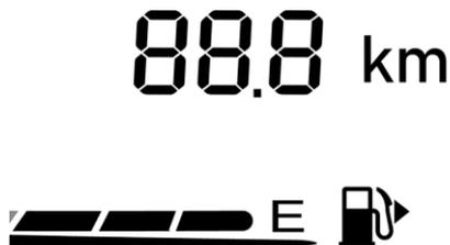
Счетчик текущего пробега показывает расстояние, пройденное в текущей поездке с момента предыдущего обнуления счетчика. Чтобы сбросить счетчик текущего пробега, нажмите на рулевом колесе кнопку «вниз» и удерживайте ее 2 секунды.
