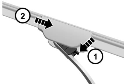
Вначале нажмите фиксатор щетки стеклоочистителя в направлении стрелки 1. Другой рукой удерживайте место соединения рычага и щетки стеклоочистителя.
