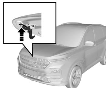
2. Когда капот приоткроется, просуньте руку под нижний край капота спереди. Потяните за ручку открывания капота вверх и полностью откройте капот.
