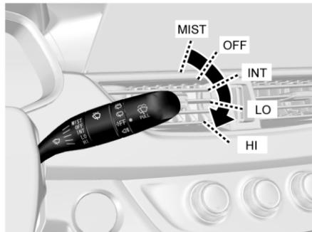
Чтобы включить передний стеклоочиститель, при включенном зажигании нажмите на рычаг управления стеклоочистителем/омывателем ветрового стекла. Стеклоочиститель ветрового стекла имеет пять режимов работы:
