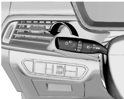
Для включения/выключения фар, задних фонарей или стояночных огней поверните конец рычага управления светом.
