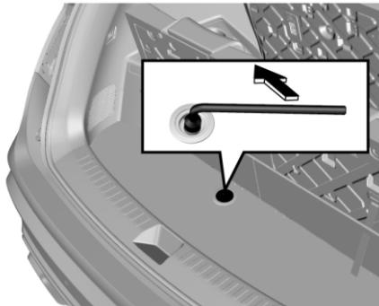
1. Откройте дверь багажного отделения и снимите коврик с пола. В дне ящика для хранения имеется болт, который служит для подъема запасного колеса.
