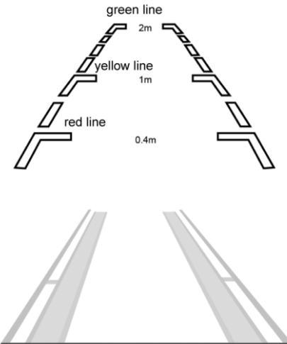
Если автомобиль оборудован камерой заднего обзора, то после включения выключателя зажигания, отпускания стояночного тормоза и установки рычага переключения передач в положение «R»
