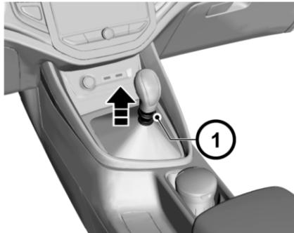
Чтобы включить заднюю передачу (R) на коробке с шестью передачами, поднимите замковое кольцо (1) и переведите рычаг переключения передач из положения N в положение R.
