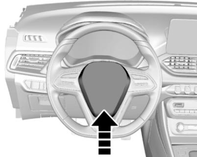
Нажмите на этот переключатель на рулевом колесе, чтобы подать сигнал клаксоном.
