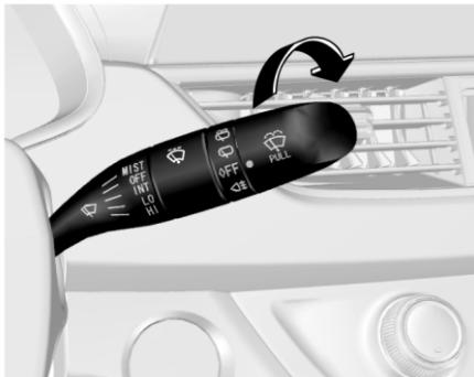
Чтобы включить задний стеклоочиститель, при включенном зажигании поверните переключатель стеклоочистителя/омывателя заднего стекла в положение . Поверните ручку переключателя стеклоочистителя/омывателя заднего стекла в положение , и водяной насос сразу подаст воду на заднее стекло. Подача воды насосом прекращается, когда вы отпускаете ручку.
