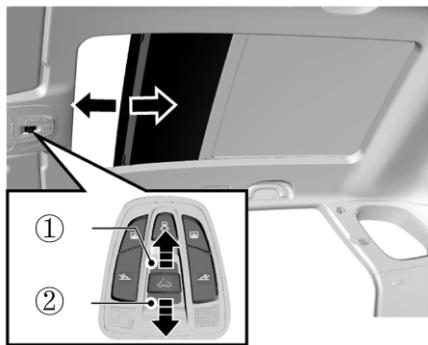
После того как панорамная крыша отклонена в полностью открытое положение, ее можно сдвинуть назад
