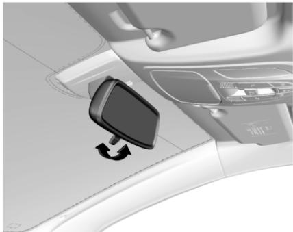
Отрегулируйте внутреннее зеркало заднего вида вручную. На некоторых моделях внутреннее зеркало заднего вида имеет антибликовую функцию, которая позволяет уменьшить блеск от фар движущихся следом автомобилей в ночное время. Чтобы активировать антибликовый режим, сдвиньте на себя переключатель в нижней части зеркала заднего вида. Не забудьте вернуть переключатель обратно при езде в дневное время.
