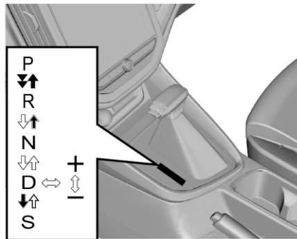
При переключении передач управляйте рычагом переключения как указано стрелками ниже:
