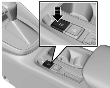
Чтобы отпустить стояночный тормоз, сначала убедитесь, что выключатель зажигания установлен в положение ON (ВКЛ), выжмите педаль тормоза и затем нажмите выключатель EPB. Индикатор работы EPB (P) погаснет, и на дисплей в комбинации приборов будет выведено сообщение «Parking brake released» («Стояночный тормоз отпущен»).
