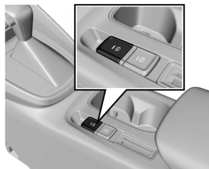
Стояночный тормоз действует на задние колеса. Выключатель стояночного тормоза с электронным управлением (EPB) находится между двумя сиденьями переднего ряда.
