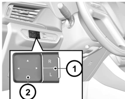
Переключатель регулировки наружного зеркала заднего вида с электроприводом находится с левой стороны панели приборов.
