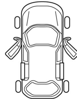
Если какая-либо из передних или задних дверей не закрыта или закрыта неплотно, загорается индикатор в форме приоткрытой двери; если не закрыта или неплотно закрыта дверь багажника, загорается или мигает индикатор в форме приоткрытого багажника.
