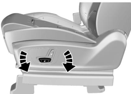
Как показано на рисунке, поверните выключатель регулировки высоты на наружной стороне подушки сиденья, после установки требуемой высоты сиденья отпустите выключатель.
