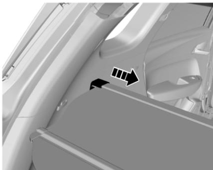
Чтобы снять шторку для багажа с автомобиля, нажмите на крышки с обоих концов втягивающего механизма шторки для багажа в направлении середины.
