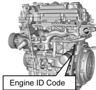
Находится на блоке цилиндров двигателя рядом с маховиком.
