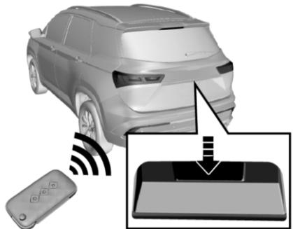
Если двери заперты и ключ зажигания находится в положении LOCK, приблизьте ключ на расстояние ближе 1,2 м от двери багажного отделения. Нажмите на кнопку двери багажного отделения, и система проверит действительность ключа. После
