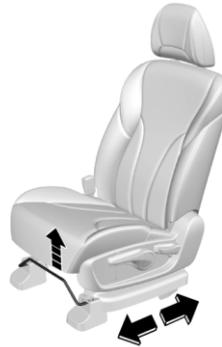
Чтобы отрегулировать положение сиденья вперед или назад, потяните вверх рычаг регулировки, установленный на передней нижней части сиденья. После установки сиденья в требуемое положение отпустите рычаг.
