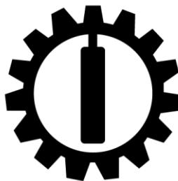
Сигнализатор неисправности коробки передач загорается на несколько секунд при включении зажигания и затем гаснет. Это показывает, что система управления сигнальными лампами исправна. В некоторых моделях этот сигнализатор при включении зажигания не загорается, а загорается только при неисправности.
