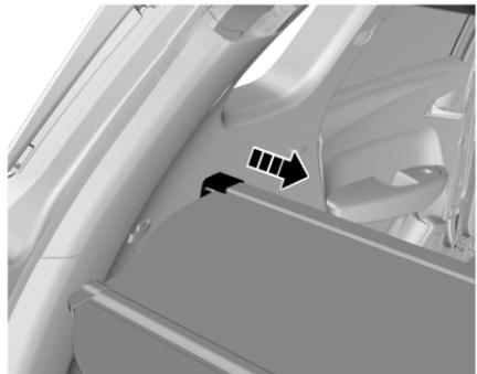
Чтобы снять шторку для багажа с автомобиля, нажмите на крышки с обоих концов втягивающего механизма шторки для багажа в направлении середины.
