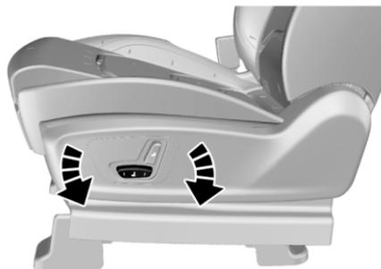
Как показано на рисунке, поверните выключатель регулировки высоты на наружной стороне подушки сиденья, после установки требуемой высоты сиденья отпустите выключатель. Положение переднего пассажирского сиденья с электроприводом не регулируется вперед или назад.
