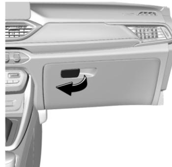
Чтобы открыть перчаточный ящик, потяните за ручку наружу. Во время движения дверца перчаточного ящика должна быть закрыта во избежание рисков травмирования при резком торможении или аварии.
