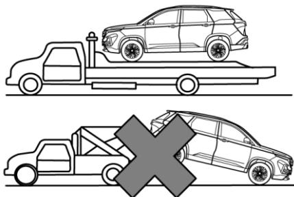
При эвакуации автомобиля на платформе установите зажигание в выключенное положение и убедитесь, что автомобиль хорошо закреплен на эвакуаторе.
