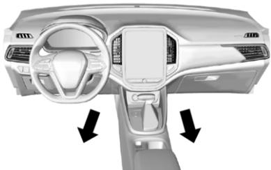
Большая часть воздуха подается через воздуховыпускные отверстия пола и нижние воздуховыпускные отверстия в зоне передних сидений; меньшая часть воздуха подается через воздуховыпускные отверстия обогревателя ветрового стекла и стекол передних дверей, а также через боковые воздуховыпускные отверстия.
