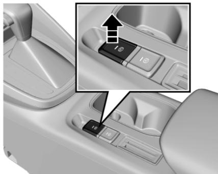
Чтобы включить стояночный тормоз, выжмите педаль тормоза для остановки автомобиля и затем оттяните выключатель стояночного тормоза с электронным управлением. При этом загорается индикатор работы EPB (P), отпустите выключатель EPB после вывода на дисплей в комбинации приборов сообщения «Parking brake applied» («Стояночный тормоз включен»).
