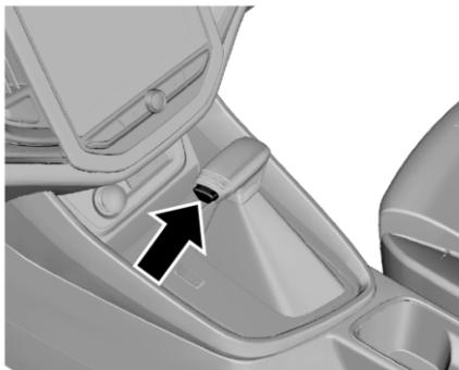
На рычаге переключения передач имеется кнопка блокировки для предотвращения случайного включения передач «P» (Парковка) или «R» (Задний ход), когда включены другие передачи. Запрещается нажимать кнопку во время движения. Нажмите эту кнопку, только когда автомобиль неподвижен, и вы собираетесь включить передачу «P» или «R».
