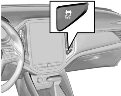
Нажмите на выключатель ESC OFF после того, как автомобиль начнет движение, на комбинации приборов загорится индикатор выключения ESC OFF, и некоторые функции ESC будут отключены.
