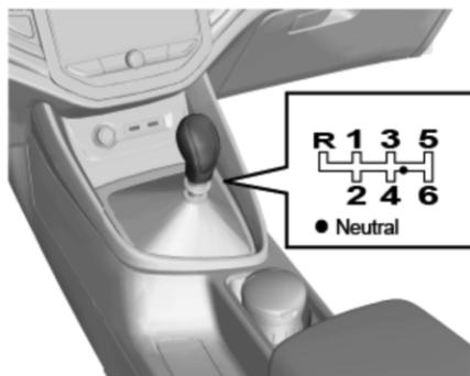
Чтобы переключить передачу, выключите сцепление и воспользуйтесь схемой, которая приведена на рычаге переключения передач. Чтобы включить заднюю передачу (R), остановите автомобиль, полностью выжмите педаль сцепления, а затем переведите рычаг из положения N в положение R.
