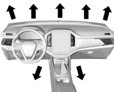
В этом режиме воздух подается через воздуховыпускное отверстие обогревателя ветрового стекла, воздуховыпускные отверстия обогревателя стекол передних дверей, воздуховыпускные отверстия пола, нижние воздуховыпускные отверстия в зоне передних сидений, а также через боковые воздуховыпускные отверстия.
