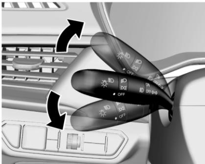
Указатели поворота/смены полосы работают только при включенном зажигании.
