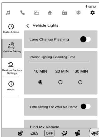
**Lane change flashing (Мигание при перестроении) :** Если функция включена, индикатор смены полосы будет мигать три раза после выключения переключателя смены полосы. Если функция выключена, индикатор смены полосы будет мигать только один раз.
